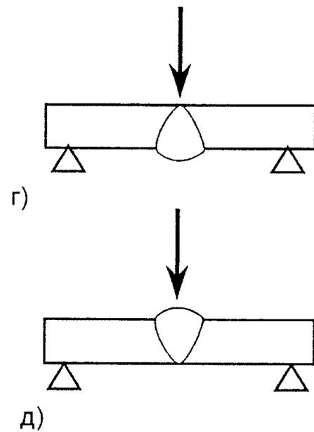
Рис. 11.1. Схемы вырезки (а), виды (б, в) и схемы испытаний на излом со стороны корня шва (г) и со стороны усиления шва (д) образцов из стыковых контрольных сварных соединений листов.
