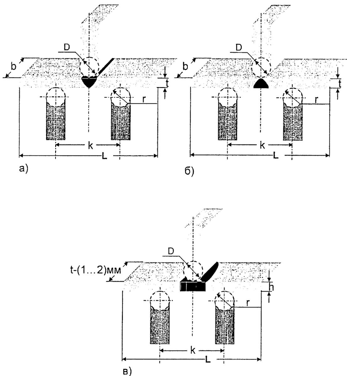
Рис. 10.1. Схемы испытаний на статический изгиб со стороны усиления шва (а), со стороны корня шва (б) и на боковой изгиб - изгиб "на ребро" (в) образцов из контрольных стыковых сварных соединений листов и труб.
