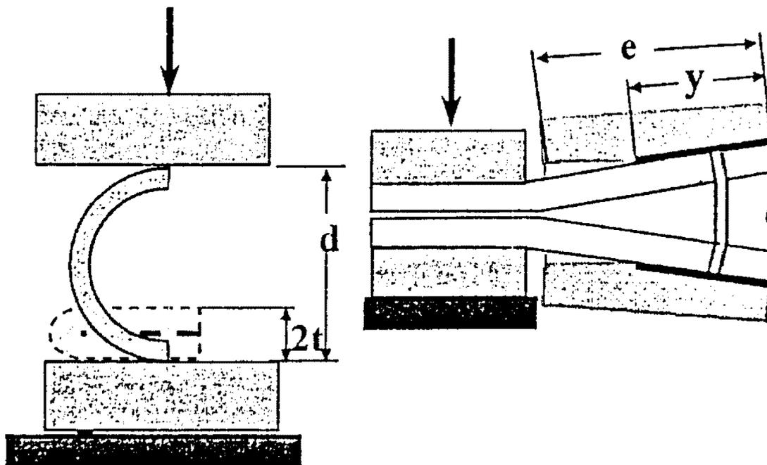
Рис. 13.2. Схема испытания на сплющивание.
