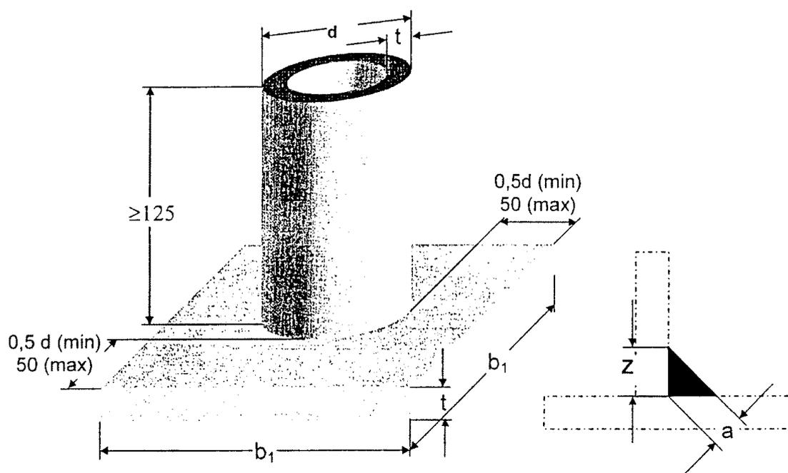
При  $t \geq 6$  мм,  $a \leq 0,5 t$ ; при  $t < 6$  мм,  $0,5t \leq a \leq (Z = 0,7 t)$ .
