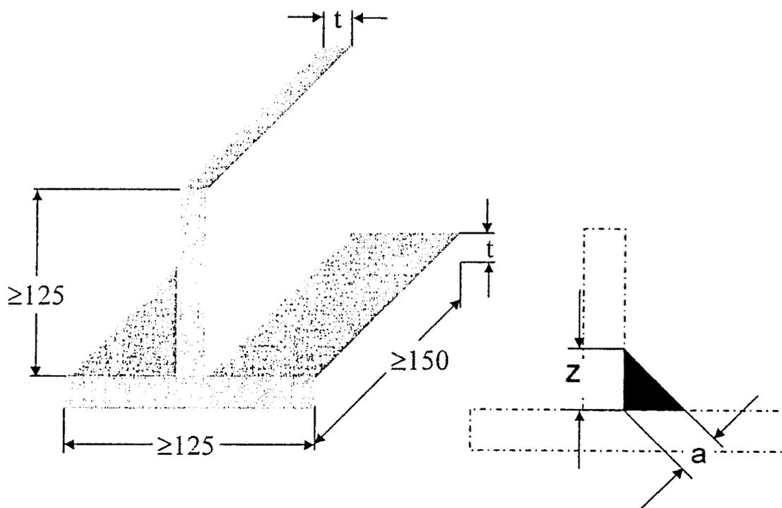
При  $t \geq 6$  мм,  $a \leq 0,5 t$ ; При  $t < 6$  мм,  $0,5t \leq a \leq (Z = 0,7 t)$
