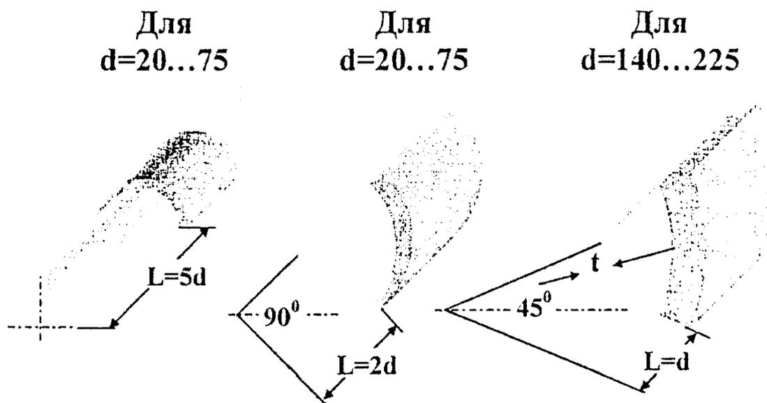
Рис. 13.1. Общий вид образцов - сегментов.
