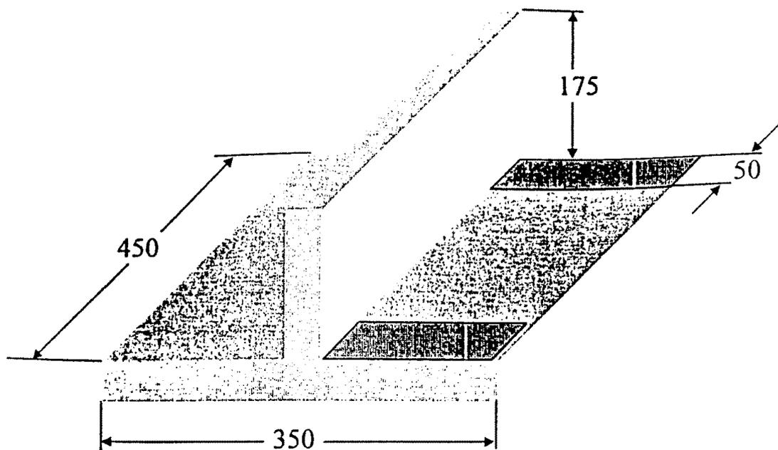
Рис. 10. Контрольные сварные соединения типов ТБ; ТВ; ТХ
