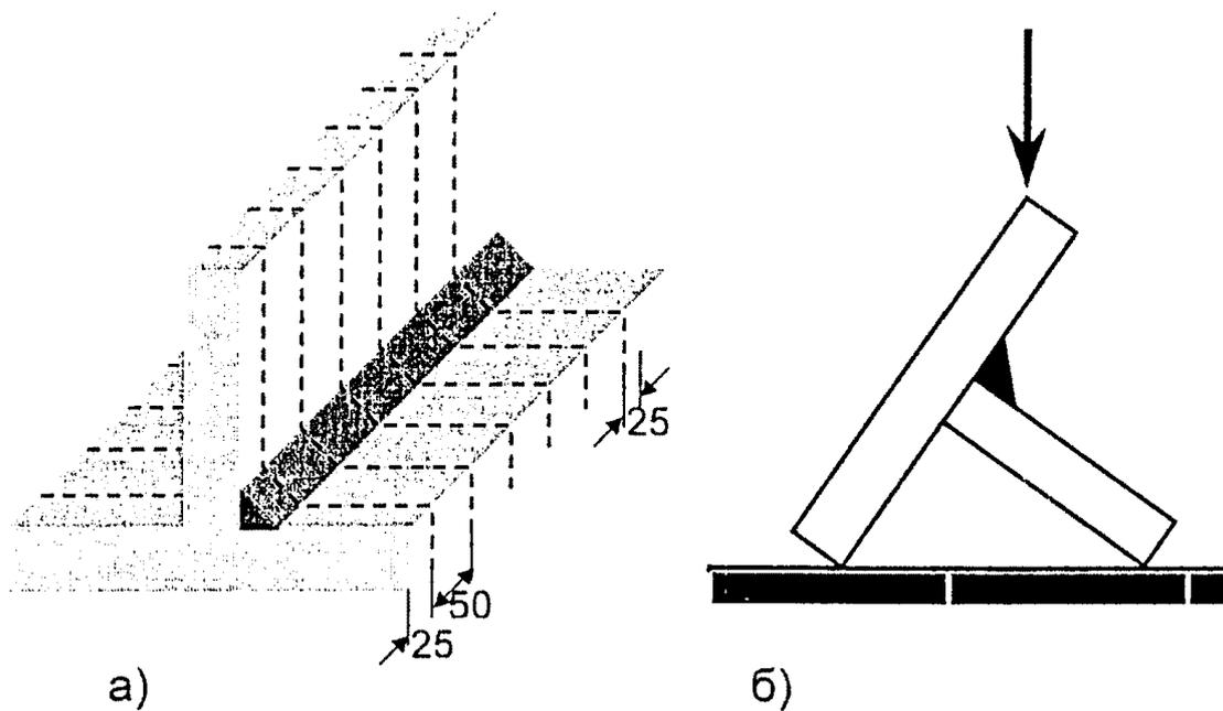
Рис. 11.2. Схема вырезки (а) и испытаний (б) на излом образцов из таврового контрольного сварного соединения листов.
