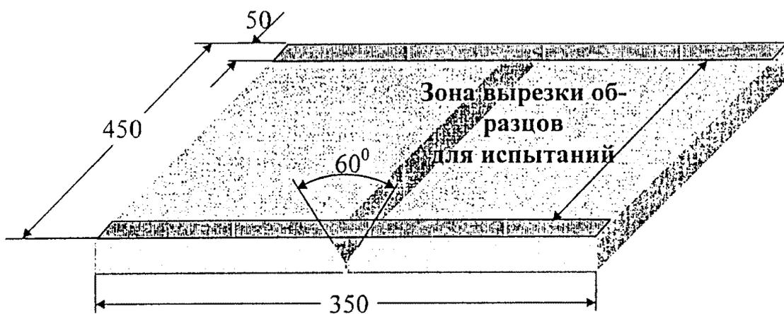
Рис. 9. Контрольные сварные соединения типов V; X
